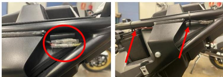
5 - CONECTAR EL MÓDULO AL CABLEADO AUXILIAR Y EMBRIDAR CABLE
