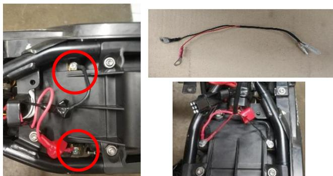
6 - CONECTAR EL CABLEADO AUXILIAR A LA BATERÍA
